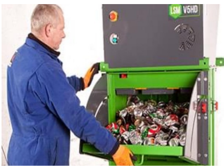
Innfallings kammer med vegger
